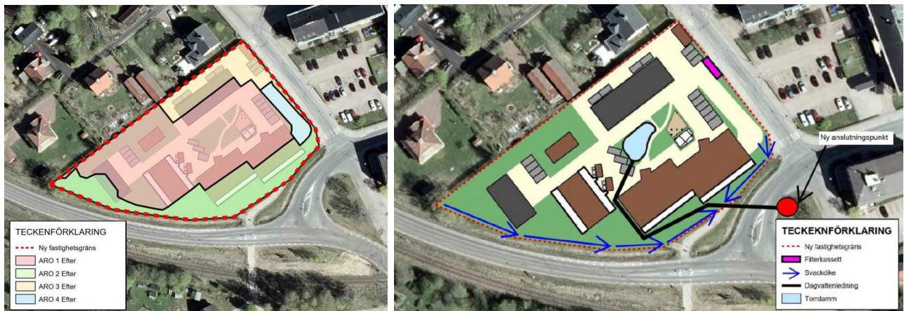
Bilden till vänster visar dagvattenytor (ARO) efter byggnationen, bilden till höger visar förslag till dagvattenhantering i planområdet.
