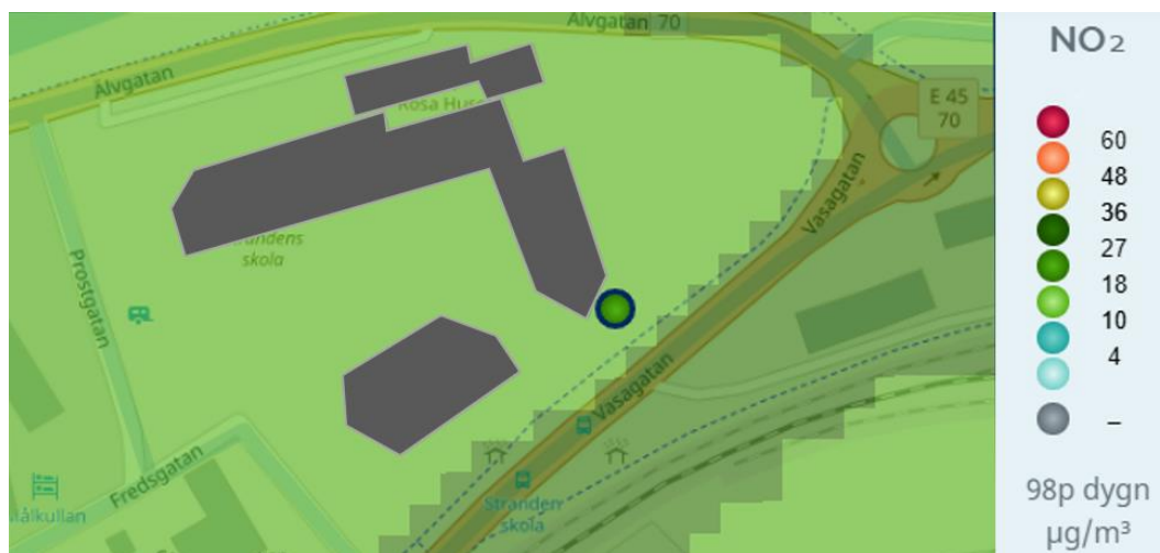
Figur 130 Resultatöversikt för framtidsscenario år 2040 avseende koncentration av NO 2 dygnsmedelvärde 98-percentil. Den gröna punkten är receptorpunkten.
